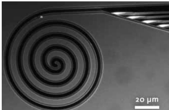
Abb. 1 bis Abb. 4: Mikroskopische Bahnen: In offenen Kanälen werden die fluoreszierenden Nanotransporter sortiert und gelenkt.
